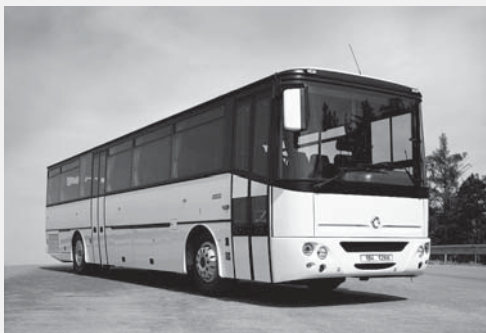
Meziměstský autobus AXER z roku 2003 – motor Iveco (228 kW), mechanická převodovka ZF, retardér Telma, lepená boční skla, kotoučové brzdy na všech kolech.
