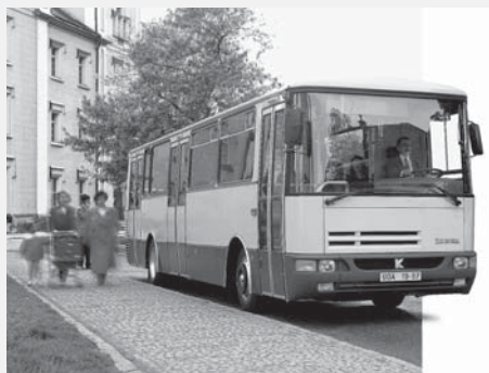
Městský autobus B 931 z první série v roce 1995 – motor LIAZ ML 636 (175 kW), třístupňová automatická převodovka VOITH D 836.3.
