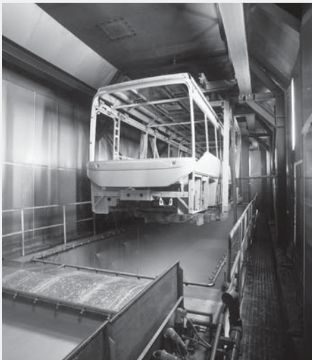
Skelet autobusu v lakovně před ponořením do lázně kataforezy.
